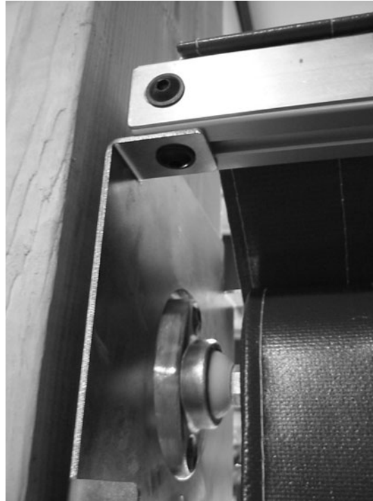
Foto #12 (Instalación del doble retén)
