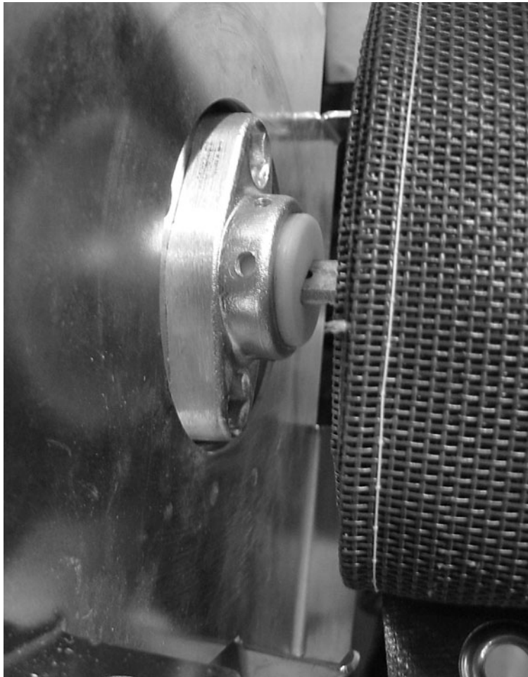
Foto #6 (Instalación de la lengüeta del resorte)
